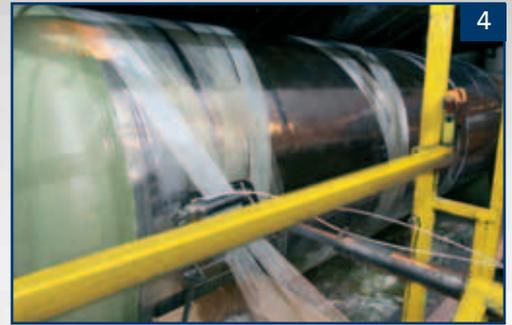
Резервуар станции изготовлен методом непрерывной машинной намотки нитей из полистирола, армированного стекловолокном (GRP). Управление производственным процессом осуществляется с помощью компьютера, что обеспечивает одинаково высокое качество и прочность во всех элементах конструкции.
