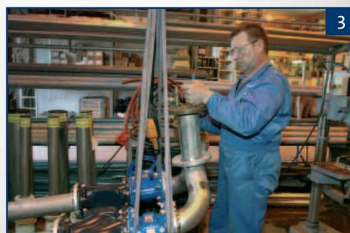
Перед поставкой оборудования все трубопроводы проходят испытания под давлением.
